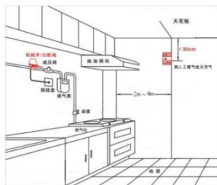
图二安装位置与安装方式
